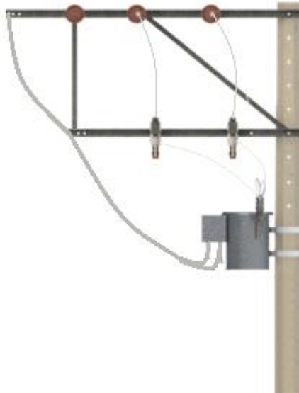
Figura 19. Montaje especial red de baja tensión “cuarta línea”
