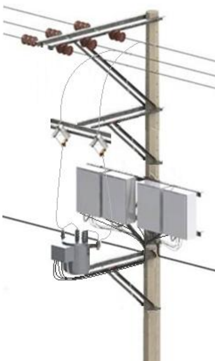
Figura 3. Medida concentrada con gabinetes de medida sobre el transformador
